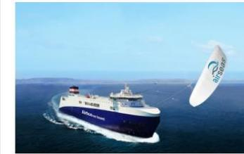
A. La voile, déployable pour une vitesse de vent comprise entre 8 et 40 nœuds, tracte les paquebots via un câble de 400 m de long. — Photo : Airbus
